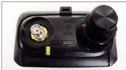
Bild 2: Draufsicht, links die SMA-Buchse; oben ist auch die GPS-Antenne integriert.
