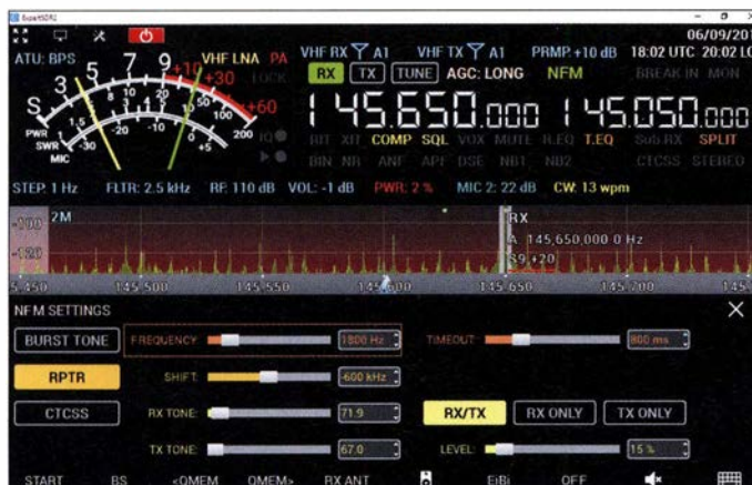
Bild 16: Im NFM-Konfigurationsfenster – erreichbar durch verlängertes Drücken der Tasten MD oder MU – finden sich Einstellmöglichkeiten für Tonruf, Relaisablage und CTCSS.
