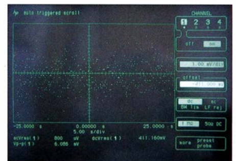
Bild 4: Rauschspannungswerte beim Differenzbetrieb beider Spannungsversorgungen und höchster Zeitauflösung
