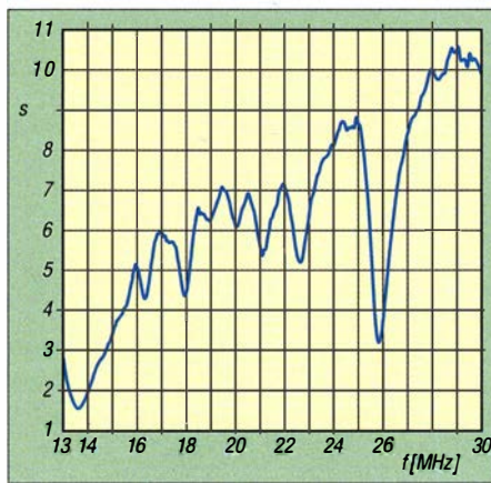
Bild 9: Gemessener SWV-Verlauf des Dipols aus Flachbandkabel mit 2 x 5,30 m Länge
