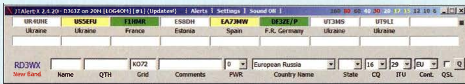
Bild 1: Zusatzprogramm JTAlert; die unterschiedlichen Farben dokumentieren den Status einer angezeigten Station, darunter „gearbeitet“ oder „mit QSL bestätigt“.
