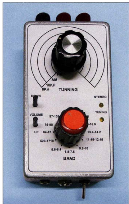
Bild 1: Fertig aufgebautes Empfänger für UKW, Mittel- und Kurzwelle im handlichen und robusten Aluminiumgehäuse
