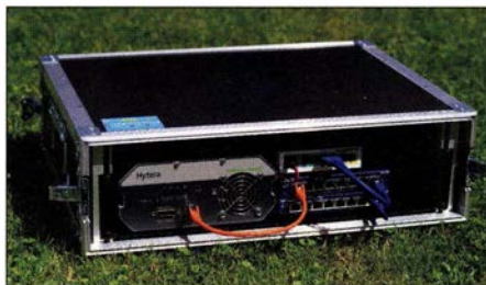
Transportables Notfunkrelais LX0E in einem stabilen Flugkoffer Foto: LX2CS
