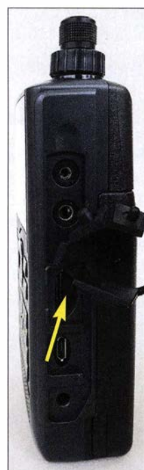
Bild 7: Die Einstellung der Rauschsperrung erfolgt über die Zweitfunktion der Monitor-Taste.
