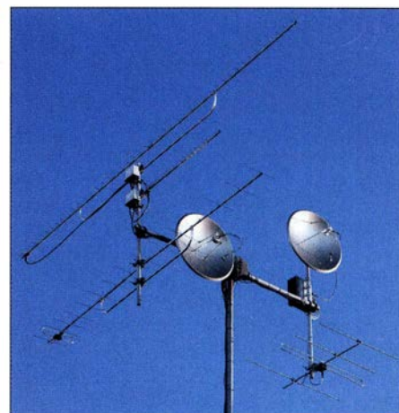
Antennenanlage von DC8EC, li. Yagis für 23, 13 und 70 cm sowie Spiegel für den Rest; re. etwas „untergeordnet“ die 2-m-Yagi Foto: DC8EC
