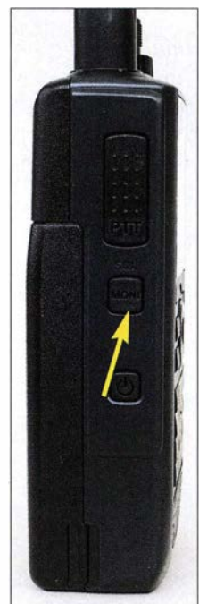
Bild 7: Die Einstellung der Rauschsperrung erfolgt über die Zweitfunktion der Monitor-Taste.
